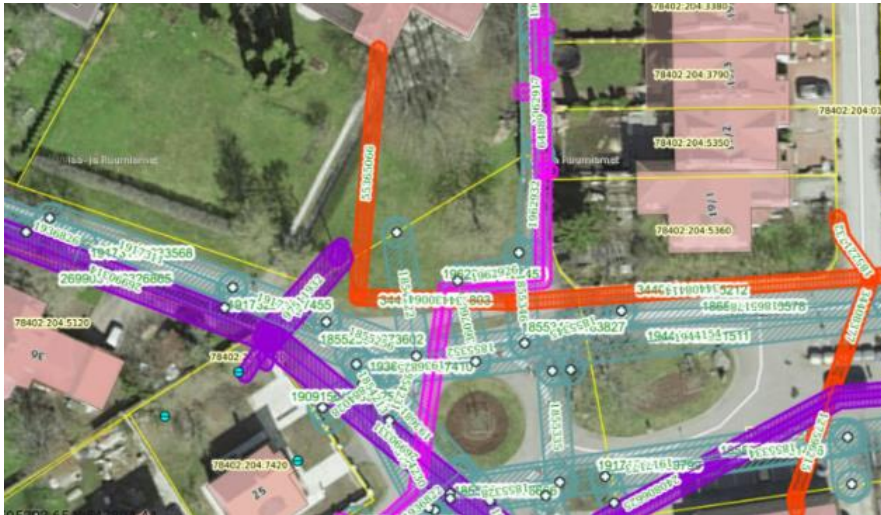
Skeem 3. 1. Helesinine - vesi, kanalisatsioon, sadevesi 2. Oranž – side, internet 3. Lilla - elekter 4. Roosa - gaas.
